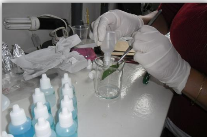
Figura 2.3 Lavagem de folhas de pinha para estimativa dos depósitos do corante Azul Brillhante.
