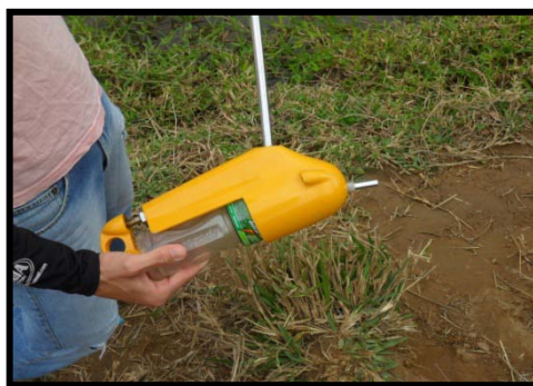
Figura 4. Amostrador de sedimentos em suspensão modelo US DH-48.
