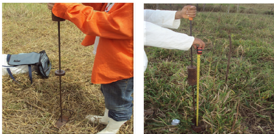
Figura 7. Coleta de dados para determinação da resistência a penetração com uso do penetrômetro de impacto.
