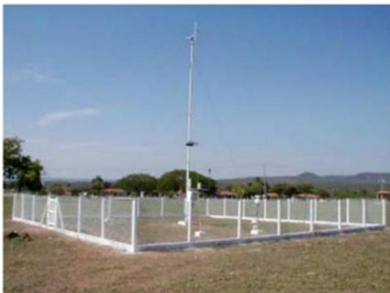
**Figura 14** – Típica Estação Meteorológica Automática do INMET, sensores, mastro com caixa data-logger, painel solar, para-raios e cercado. Fonte: Nota técnica – Rede estações INMET.
