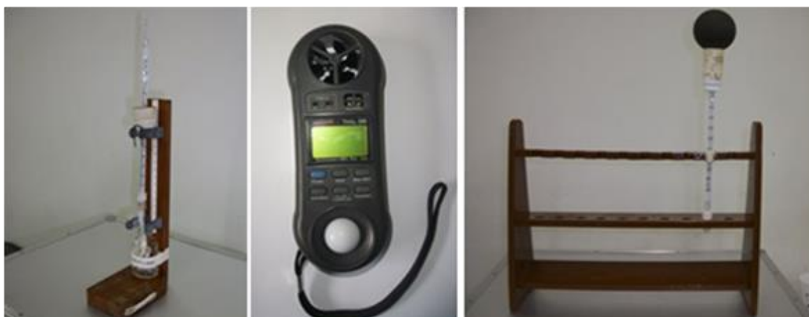
Figura 03: (Esquerda para direita) Equipamento confeccionado para medição de umidade relativa (%), THAL-300 e globo negro confeccionado para medição de temperatura radiante. Fonte: Autor.
