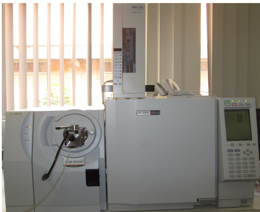
Figura 4: Cromatógrafo gasoso Shimadzu, acoplado ao detector de massas.
