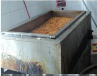
**Fritar os biscoitos:** consiste em pegar os biscoitos preparados e colocá-los na fritadeira com óleo quente, onde são virados, até atingir o ponto. Com auxílio de uma peneira metálica, os biscoitos são retirados da fritadeira e colocados na bancada para resfriar.
