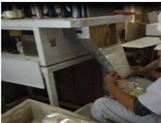
**Embalar os biscoitos com auxílio de uma máquina embaladeira:** manualmente abastece-se o silo da máquina, posiciona-se a embalagem na saída da máquina, automaticamente, os biscoitos são embalados. Na sequência, a embalagem é colocada na seladora para ser fechada e, posteriormente, levada para o setor de expedição.
