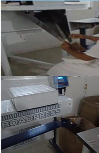
**Embalar os biscoitos com auxílio de uma máquina embaladeira:** manualmente é abastecido o silo da máquina, posiciona-se a embalagem na saída da máquina, automaticamente, os biscoitos são embalados. Na sequência, a embalagem é colocada na seladora para ser fechada e, posteriormente, levada para o setor de expedição.
