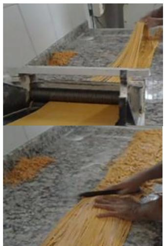
**Moldar os biscoitos tipo “pimentinha”:** a massa é colocada no cilindro moldador, que a molda e, na sequência, com auxílio de uma faca, é cortada no tamanho desejado.
