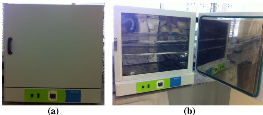
**Figura 33** - Ilustração de processo de determinação do teor de cinzas das amostras das farinhas dos resíduos de abacaxi, acerola e cajá. a) Visão externa; b) Visão interna da estufa de secagem e esterilização SX-DTME - Prolab, Brasil.
