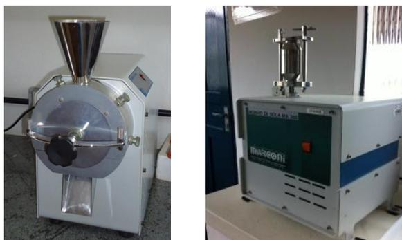
**Figura 32** - Equipamentos para trituração das amostras. a) Moinho de facas; b) Moinho de bola.
