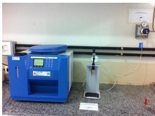
**Figura 39** - Bomba calorimétrica digital (IKAWORKS - C200).
