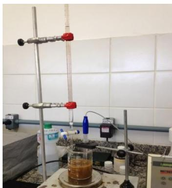
**Figura 37** - Ilustração do procedimento de determinação potenciométrica de acidez titulável da farinha do resíduo da acerola.
