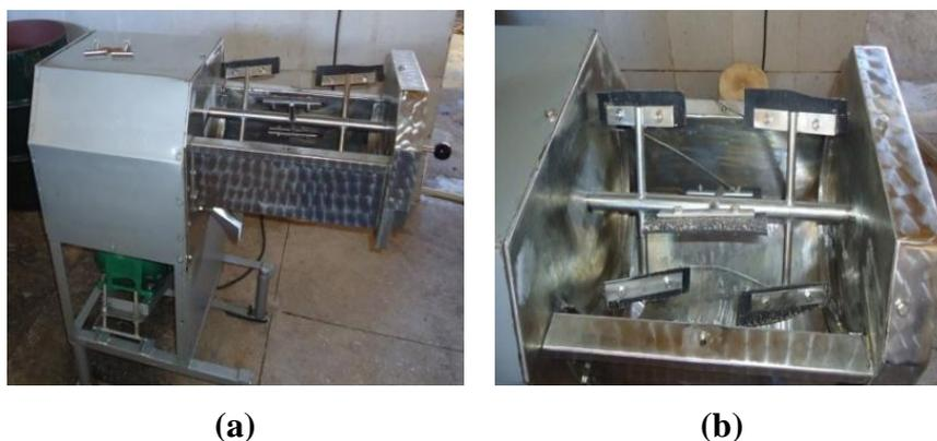
**Figura 28** - Equipamentos para despoldar e refinar as polpas. a e b) Despoldadeira.
