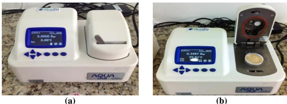
**Figura 38** - Aparelho Aqualab 4TEV. a) Visão frontal do aparelho fechado; b) Visão frontal do aparelho aberto com a amostra da farinha de abacaxi.
