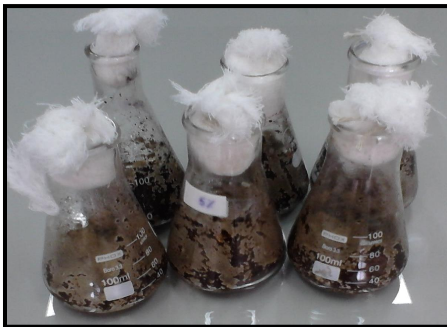
Figura 1.8 – Fermentação em estado sólido. Fonte: A autora.
