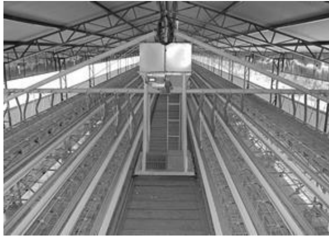
Figura 6 – Ilustração do sistema de alimentação dos comedouros das aves utilizados no local.
