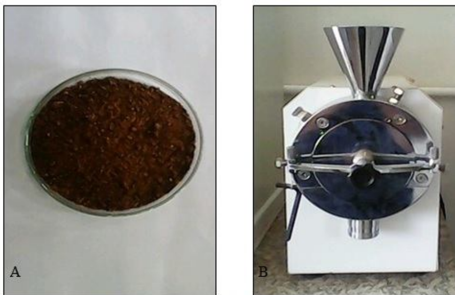
Figura 7 - A) Resíduo de cacau moído para fermentação; B) Moinho de facas. Fonte: O autor
