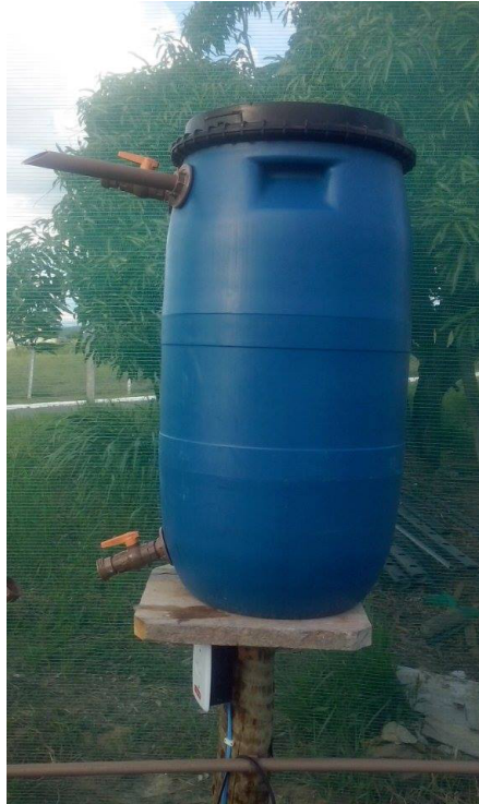
Figura 3: Tambor de polietileno, utilizado como filtro biológico. Itapetinga – BA. UESB 2015.
