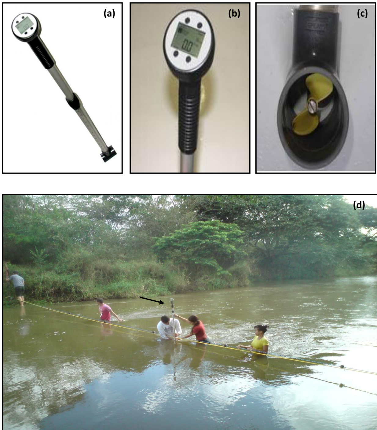
Figura 7. - Molinete hidrométrico (a), detalhe do display (b), hélice do equipamento (c) e medição da velocidade média do fluxo com a utilização do molinete.
