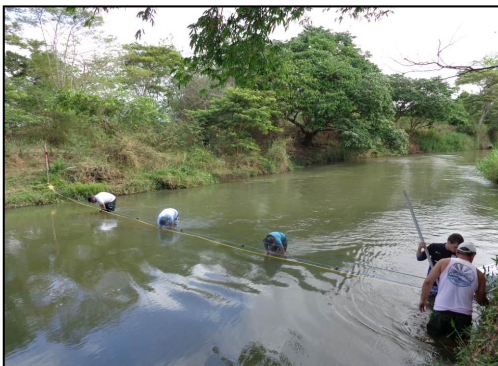
Figura 6. Coleta das amostras de água na seção transversal do rio Catolé Grande, segundo as metodologias de coleta da CETESB (1988) e NBR 9897/87.
