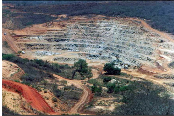
Figura 26: Jazida da Cachoeira. Bancadas de 5 metros de altura e bermas de 3 metros de largura. Profundidade de 50 metros. (Outubro de 2003)[9].
