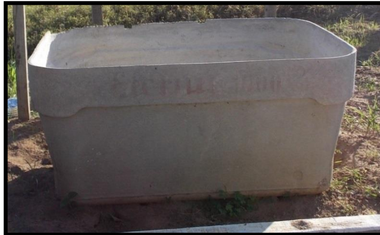
Figura 9. Tanque de amianto onde os dejetos ficaram armazenados (DSI)
