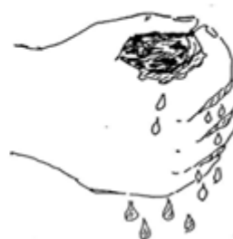
Figura 4. Umidade em excesso
