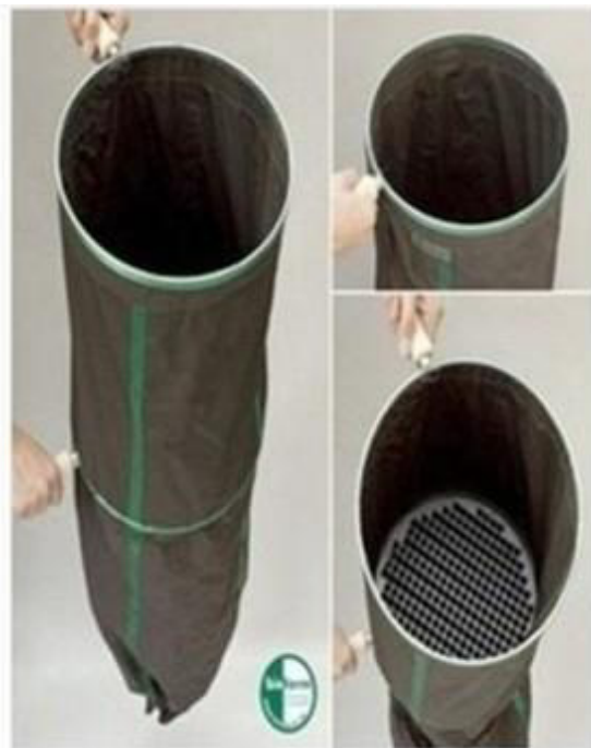
Figura 5 –Concentrador de serapilheira conhecido como Winkler Sifter, sendo composto por uma peneira circular e um saco de tecido. Fonte: https://marizetedobrasil.loja2.com.br
