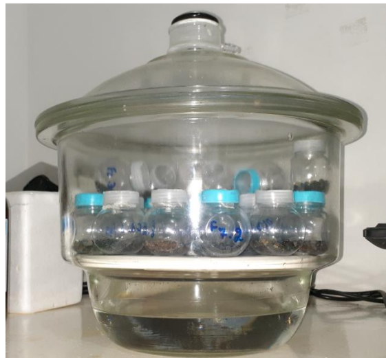
Figura 7: Teste de permeabilidade ao vapor de água
