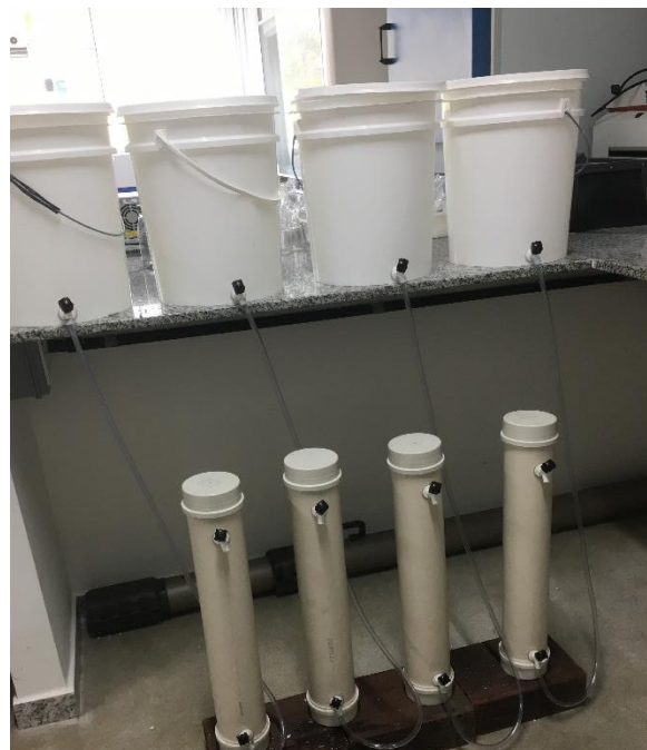
Figura 1: Banca experimental composta por 4 filtros anaeróbios confeccionado com tubos de PVC.
