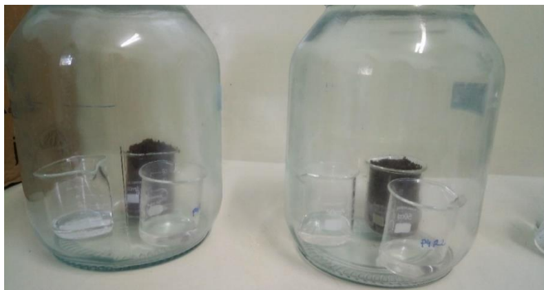
Figura 8 – Recipientes utilizados para a incubação, juntamente com a amostra de solo e seus respectivos béqueres contendo NaOH e água.
