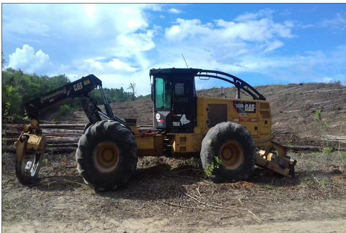
Figura 3 – Skidder Caterpillar, modelo 555 D. Fonte: Acervo da autora (2019).
