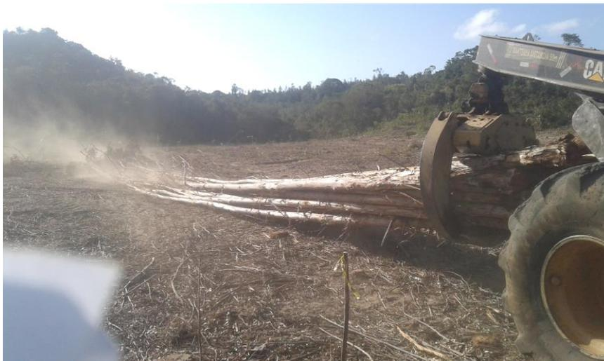
**Figura 5** – Skidder carregado trafegando sobre a linha de plantio no processo de extração florestal.
