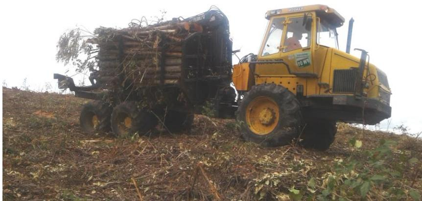
**Figura 8** – Forwarder da marca Randon, modelo RK 614H.
