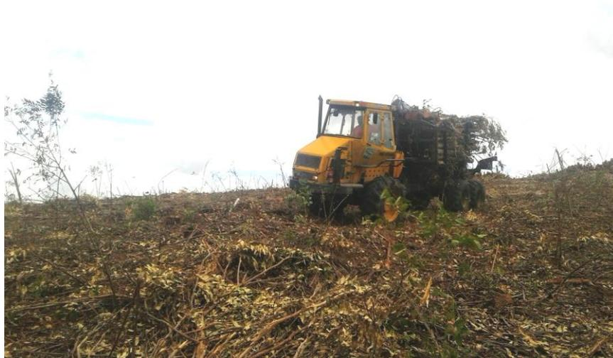
**Figura 10** – Forwarder carregado trafegando sobre a linha de plantio no processo de extração florestal.
