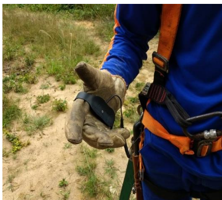
Figura 3 – Acelerômetro posicionado na mão do podador para levantamento quantitativo de vibração.
