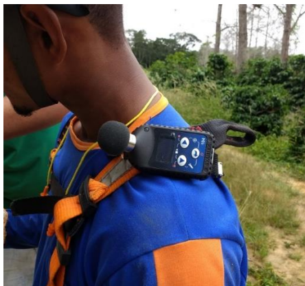
Figura 2 – Dosímetro posicionado em podador para levantamento quantitativo de ruído.
