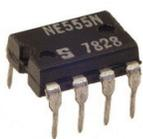
**Figura 11-**Circuito integrado NE555
