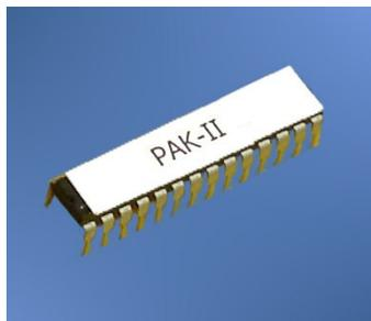
**Figura 14-**Co-processador aritmético Pak-II
