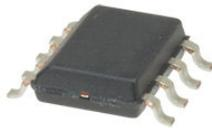
**Figura 8-**Circuito integrado MAX 6674
