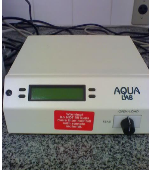
Figura 5 – O determinador de atividade de água (AQUALAB) do laboratório de propriedades físicas de materiais biológicos do CEDETEC/UESB.
