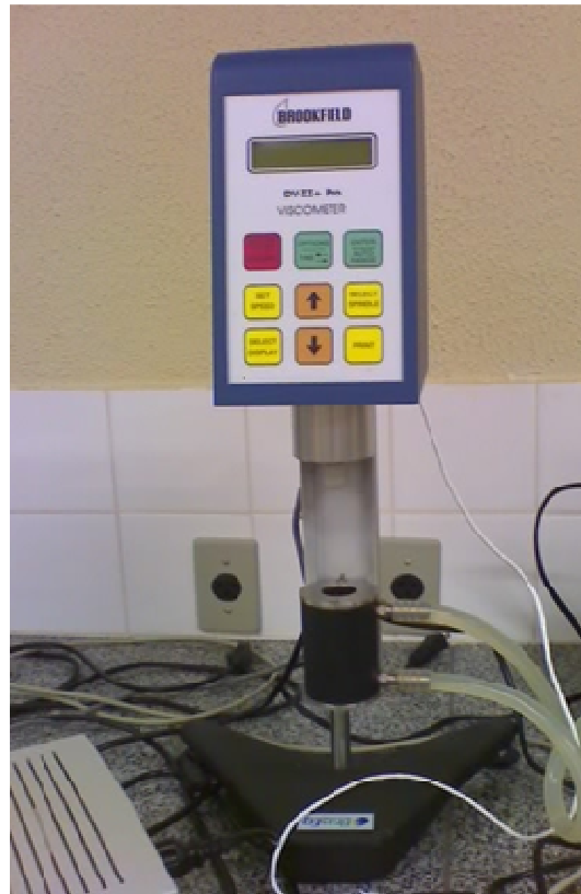
Figura 3 - Reômetro Brookfield DVII+ Pro do laboratório de propriedades físicas de materiais biológicos – CEDETEC/UESB.
