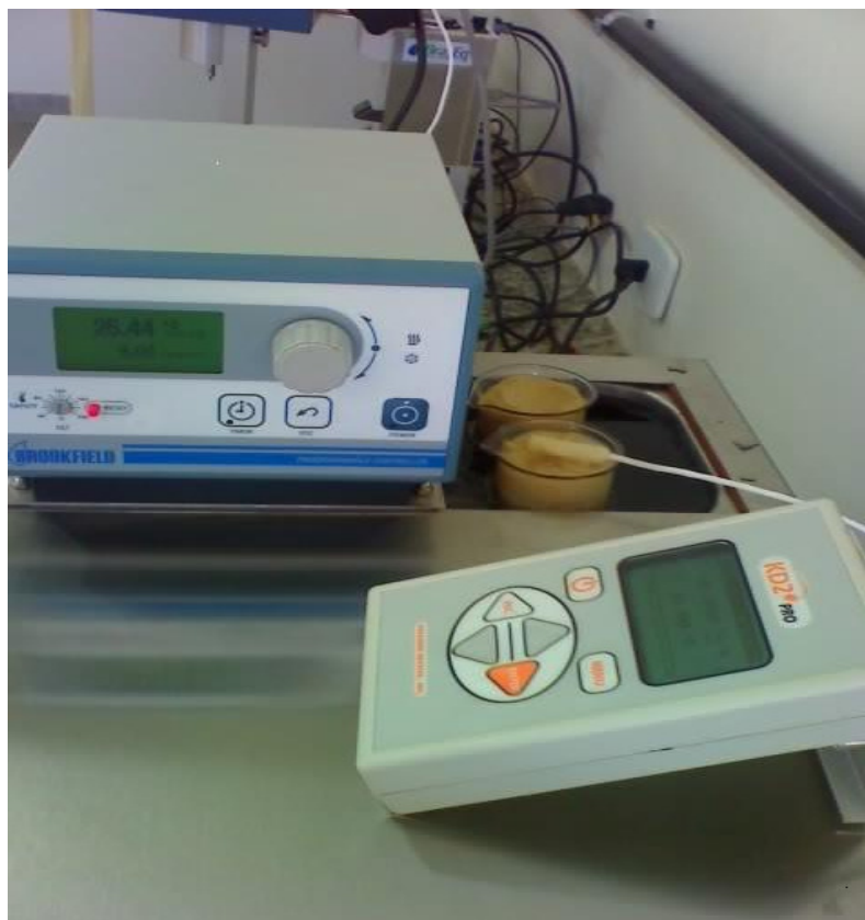
Figura 9 - Sistema utilizado na medição das propriedades termofísicas.
