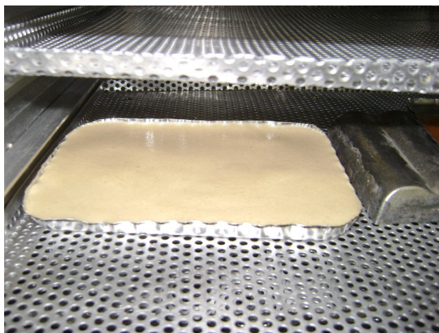
Figura 13. Espuma do extrato de própolis em bandeja de alumínio dentro do secador.
