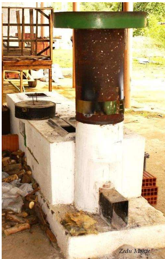
Figura 16- Gaseificador concorrente finalizado e testado.
