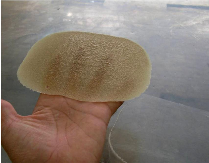
**Figura 5 - Espuma do caldo de cana seca desprendida completamente do leito de secagem.**
