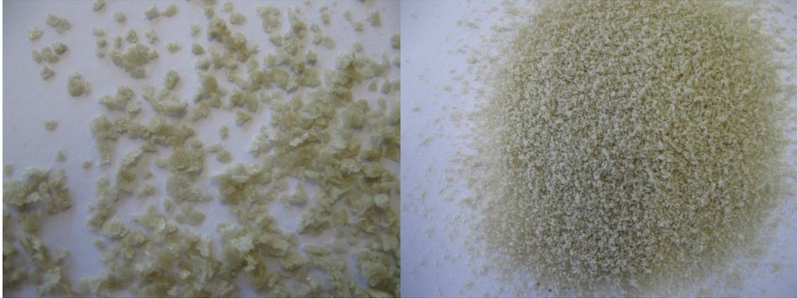
**Figura 14 - Flocos (esquerda) e pó de caldo de cana desidratado em leito de espuma.**
