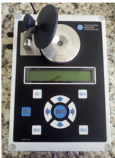
Figura 4. Refratômetro digital de bancada DSA E-Scan (The Electron Machine Corporation) do Laboratório de Propriedades Físicas de Alimentos do CEDETEC/UESB.
