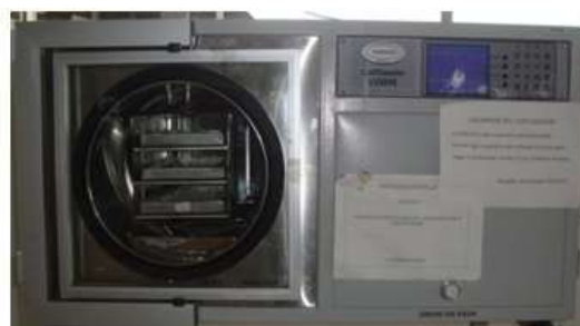
Figura 11 - Liofilizador com três bandejas carregadas de resíduo.
