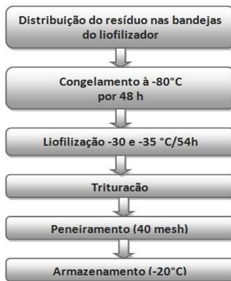
Figura 9 - Fluxograma do processamento de resíduo de graviola liofilizado.
