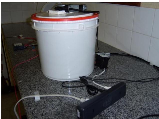
**Figura 26** – Sistema sem compensação de solução montado para desidratação osmótica de maçã
