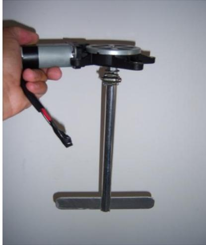
**Figura 16** – Agitador construído para o tanque de desidratação do protótipo
