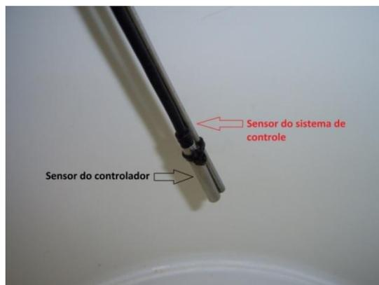
**Figura 22** – Posicionamento dos sensores para verificação do sistema de medição construído
