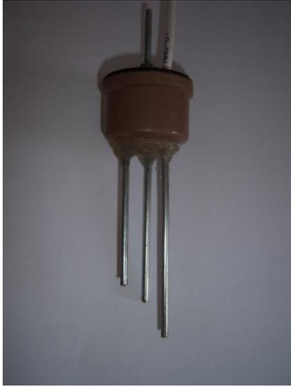
**Figura 1B** - Sensor de nível por condutividade
