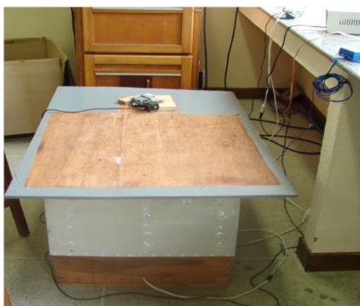
**Figura 4** - Banho termostático construído para o estudo da aplicação de modelos matemáticos na desidratação osmótica de frutículos de jaca
