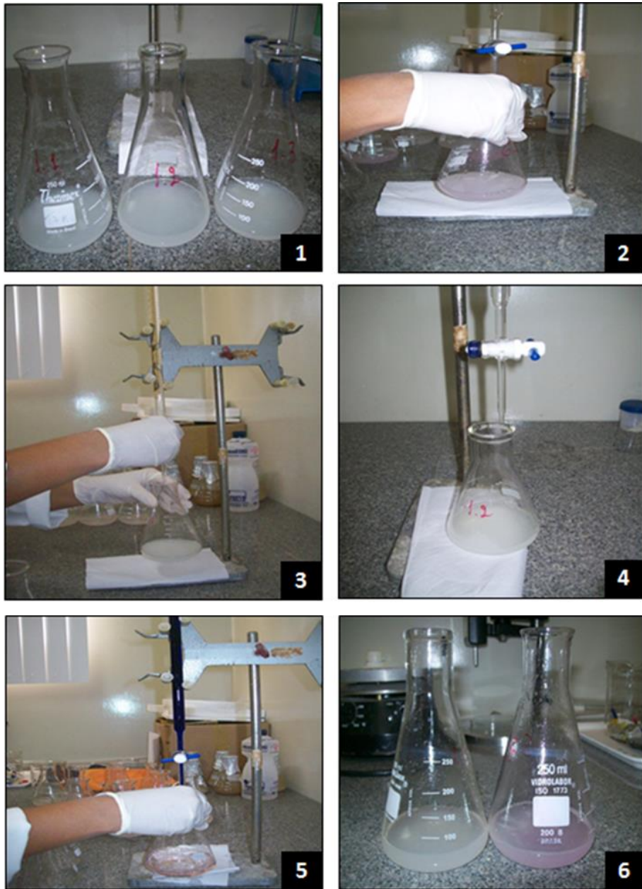
Figura 2: Amostras para acidez titulável (1). Titulação com NaOH 0,1N (2, 3 e 4). Titulação com Tilman para ácido ascórbico (5). Ponto de viragem de cor após titulação (6). Foto: MORAES, M. O. B., 2012.
