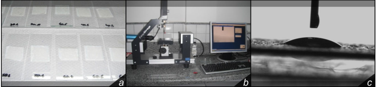
Figura 08: Análise de Hidrofobicidade: a) amostras de filmes fixados em laminas; b) Equipamento; c) Imagem da gota formada.
