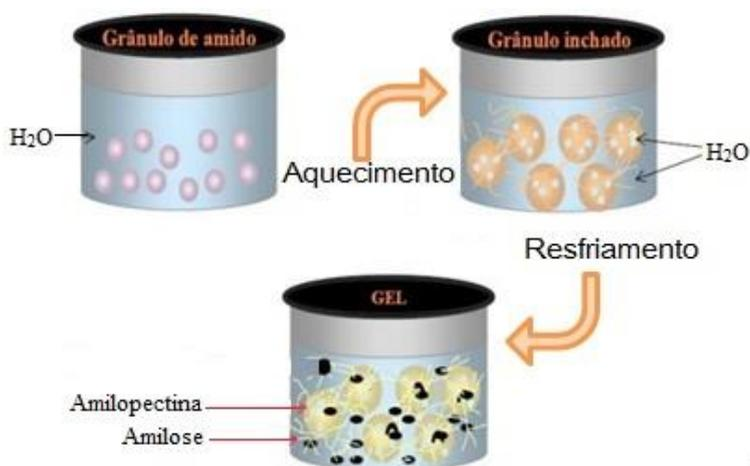
**Figura 3.** Grânulos de amido em suspensão, em processos térmicos. Adaptado de IZIDORO et al. (2011).
