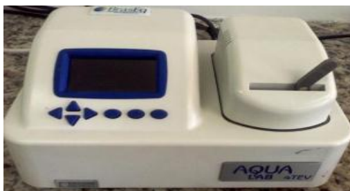
Figura 7. Aqualab digital de bancada 4TEV (Decagon Devices) do Laboratório de Propriedades Físicas de Alimentos do CEDETEC/UESB.
