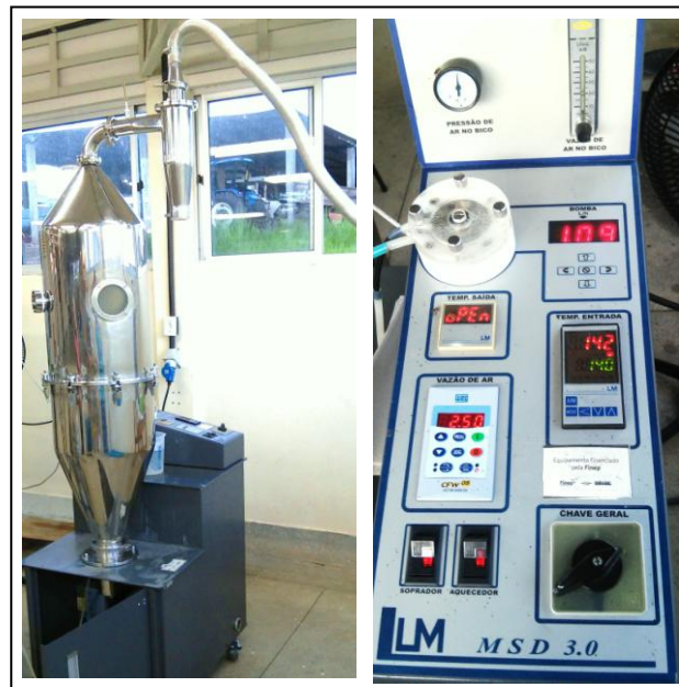
Figura 7. Secador spray dryer utilizado na secagem da polpa de noni. Fonte: Pesquisa.
