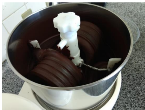
Figura 2. Ilustração das etapas de moagem, mistura, conchagem e refino na Melanger Spectra 11
