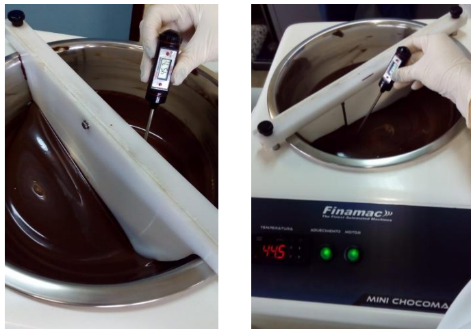
Figura 3. Temperadeira utilizada no processo de temperagem do chocolate.
