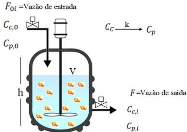
**Figura 8.** Esquema do Reator de hidrólise utilizado no modelo.
