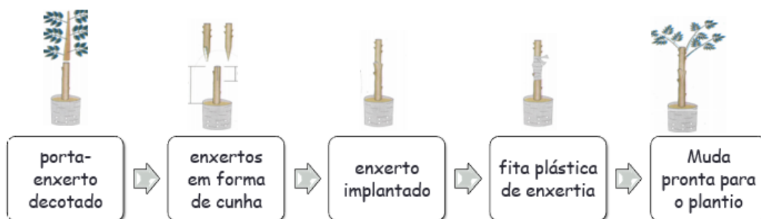
Figura 5. Enxertia de umbuzeiro por garfagem no topo em fenda cheia.
