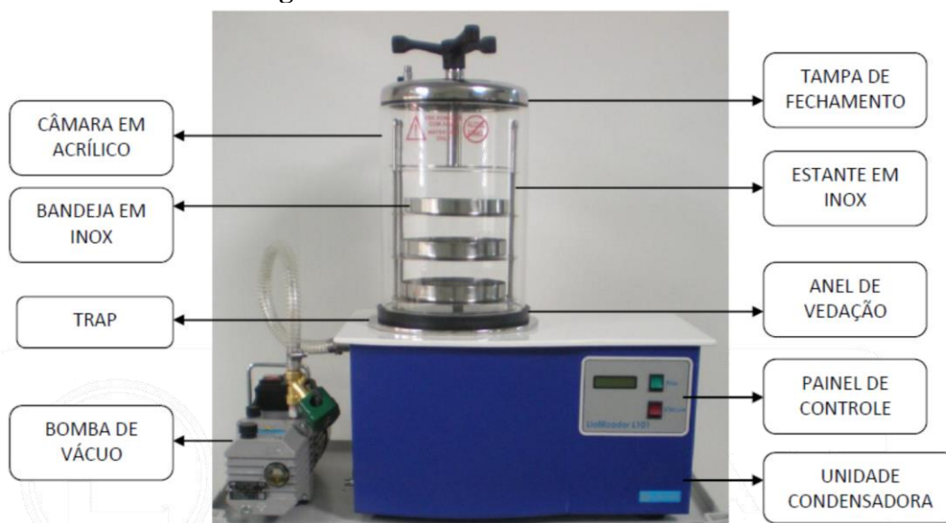
Figura 15. Estrutura de um liofilizador.
