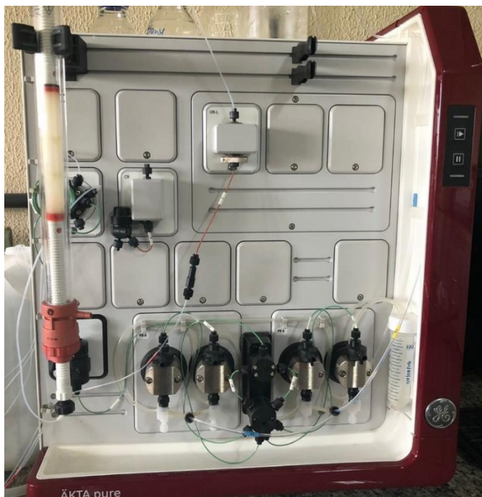
Figura 12. Cromatógrafo Akta Pure para purificação de proteínas.
