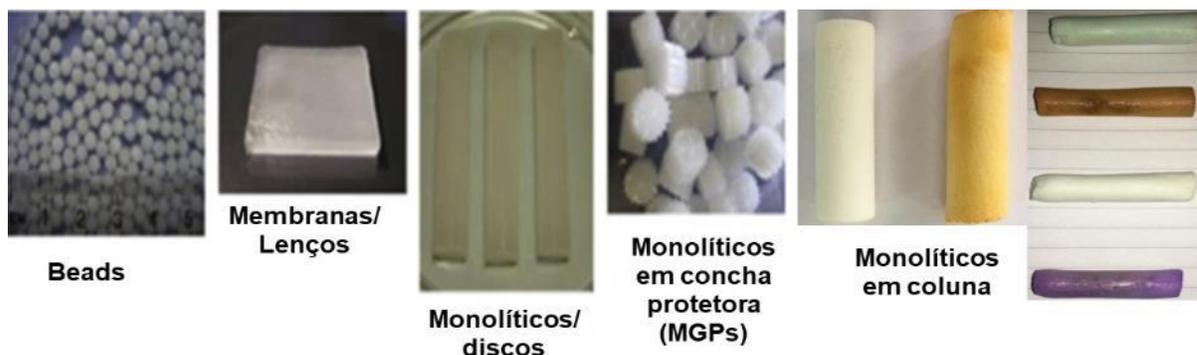
**Figura 5-** Criogéis sintetizados em diferentes formas
