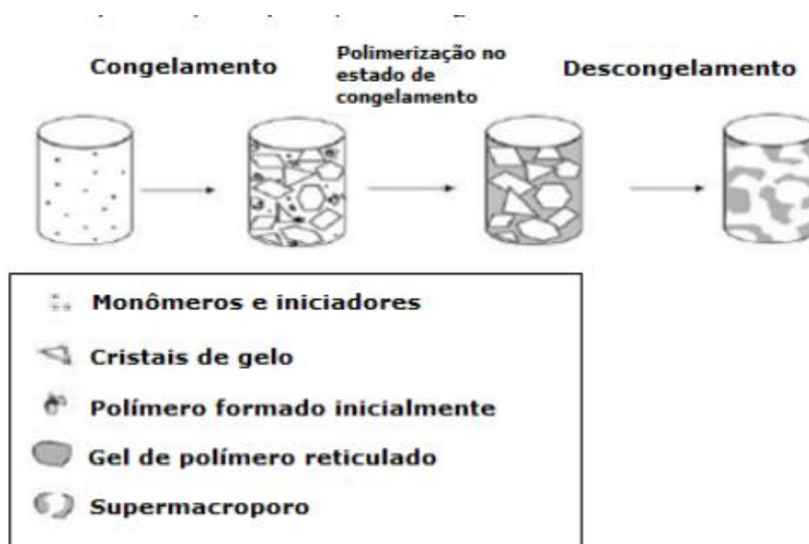
Figura 1. Representação da Produção de um Criogel.
