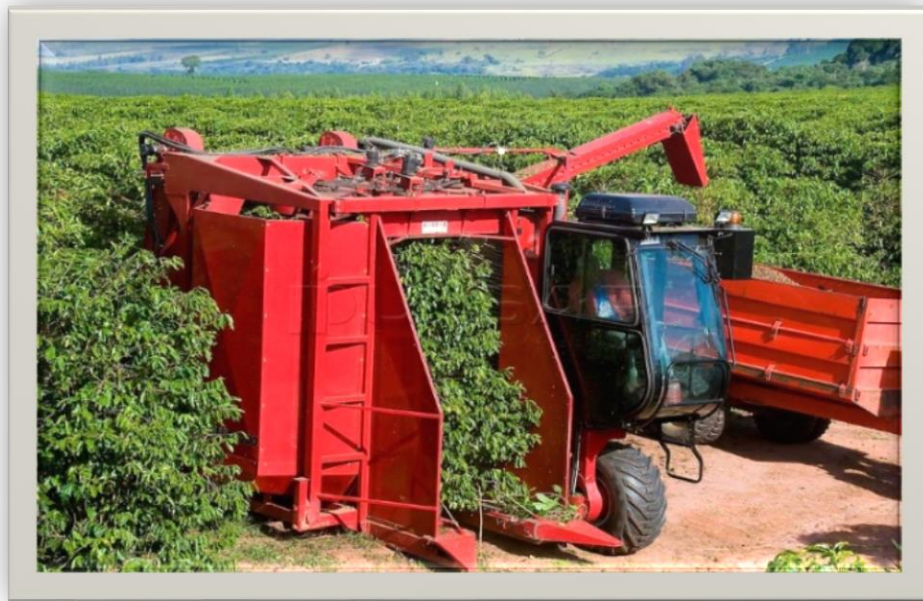
Figura 111: Colheita de Café sendo realizada pela Máquina Colheitadeira
