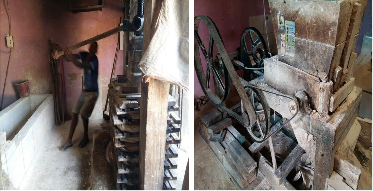
Figuras 32 e 33 – Prensa com a massa para fazer farinha e máquina para ralar mandioca em Boa Vista da Tapera.
