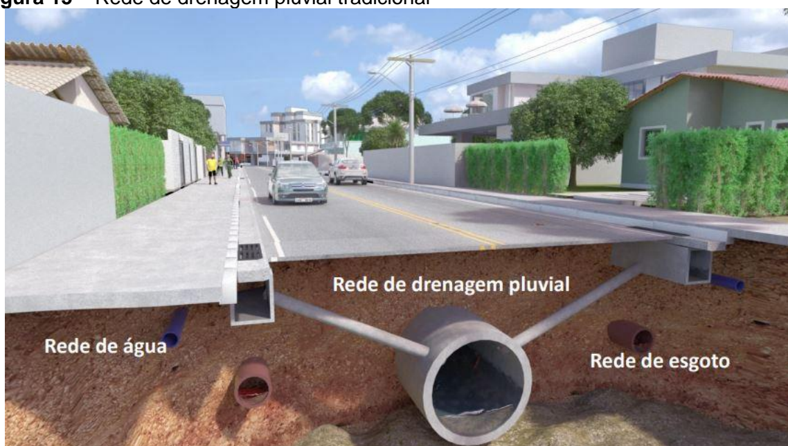
Figura 15 – Rede de drenagem pluvial tradicional
