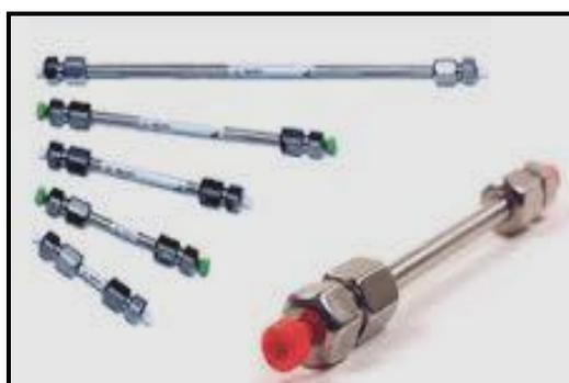
**Figura 3:** Colunas para cromatografia líquida
