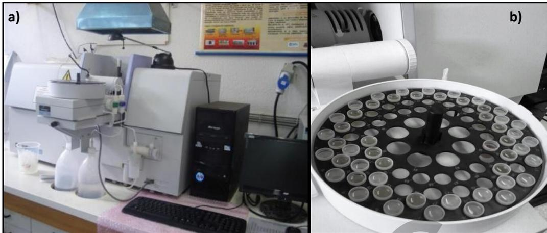
**Figura 84:** Equipamento de espectrometria de absorção atômica por forno de grafite- GF AAS (a) e o carrossel com as amostras (b)
