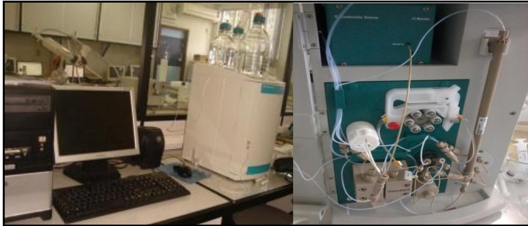
**Figura 12:** Equipamento de Cromatografia iônica
