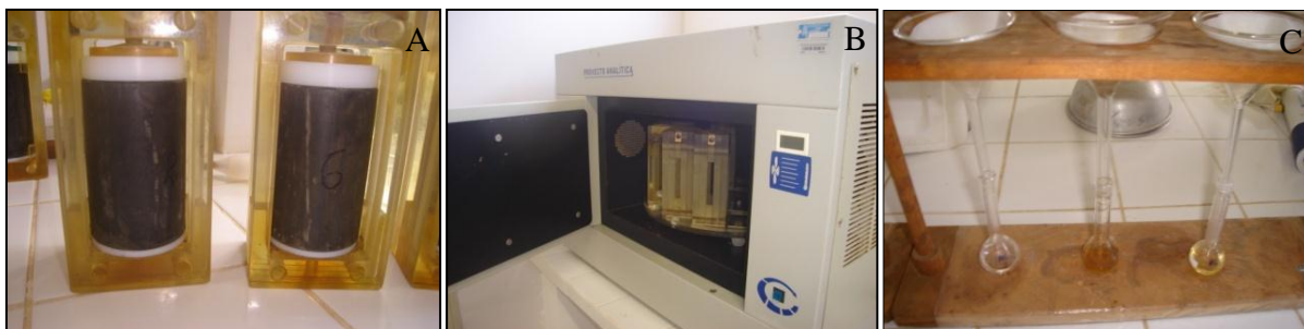
Figura 9- Equipamentos no processo de digestão ácida dos efluentes; Bombas de digestão ácida em micro-ondas (A), Sistema de digestão de amostras em micro-ondas (B), filtragem de amostras (C).
