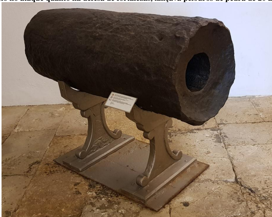
FIGURA 20 – Trom ou bombardarda grossa de ferro forjado. Portugal, c. séc. XIV-XV. Esta boca de fogo, utilizada tanto no ataque quanto na defesa de fortalezas, lançava pelouros de pedra de 20 arráteis (9 kg).
