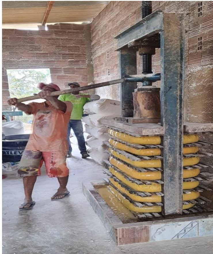
Figura 9 - Prensador da massa de mandioca na casa de farinha no quilombo de Furadinho
